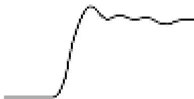
图 21: 使用接地长导线的信号
