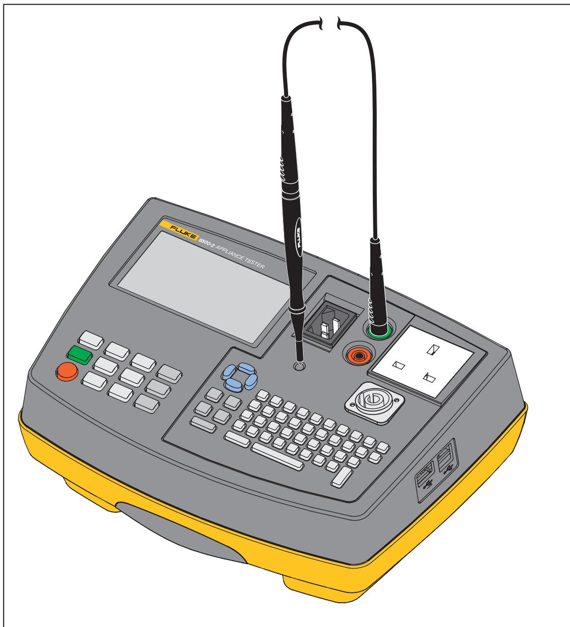
完成操作后，测试仪将显示接头调零符号  $\emptyset$ ，和测试导线的电阻值，如  $R_{PE} 0.09 \Omega$ 。将从接头测试结果中减去该值。由于保存了此调零值，您无需在每次使用测试仪时重复此操作。
