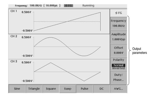
Figure 3-95: Output parameters (AWG430)
